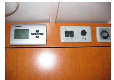
Aide 3010 ja nestekiertolettialämmittimen ohjaus ja säätö sekä automaattisen kaasupullonvaihtajan näyttö
